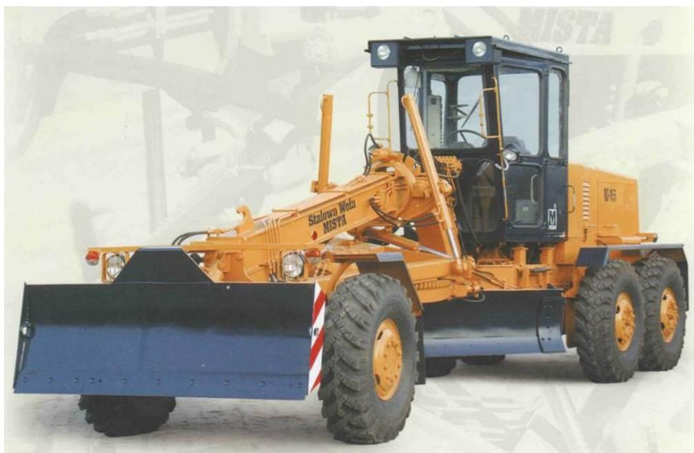
Równiarka RD155 firmy Mista, dostawa hydrostatycznego napędu przedniej osi ze sterowaniem elektronicznym
