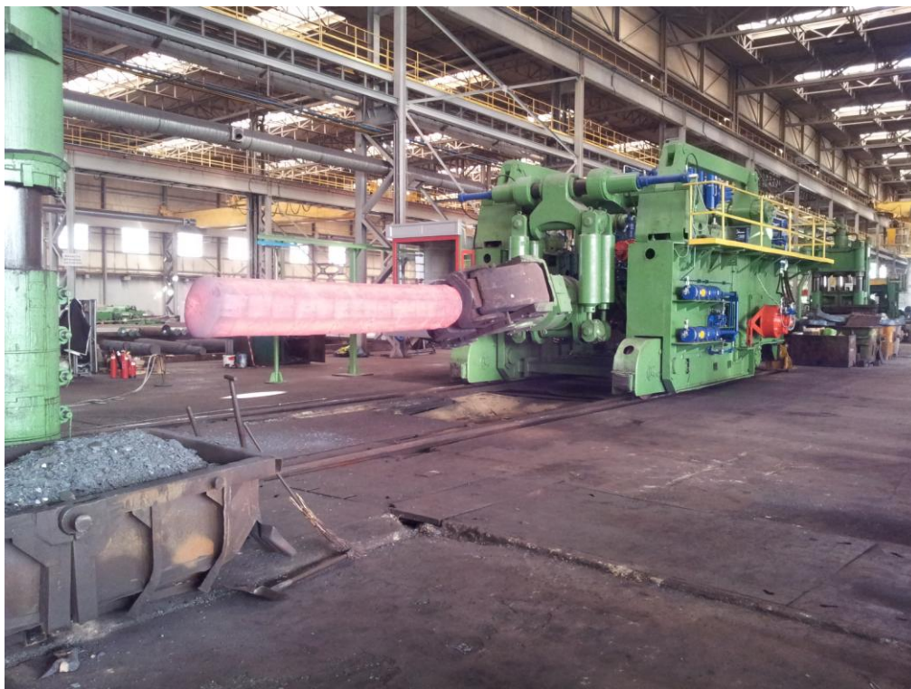
Manipulator kuzienny 30T z odkuwką trzymaną w szczypcach
